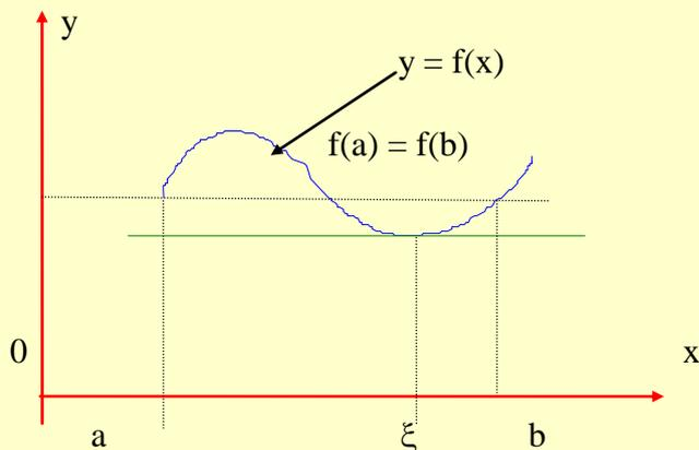
Este teorema tiene una interpretación geométrica muy sencilla. Si una curva continua, con tangente en cada uno de sus puntos, corta a una recta paralela al eje  $0x$  en dos puntos de abscisas “a” y “b”, con  $a < b$ , entonces en esta curva existirá por lo menos un punto de abscisa “ $\xi$ ” con  $a < \xi < b$ , en el cual la tangente es paralela al eje  $0x$  (por ser  $f'(\xi) = 0$ ).
